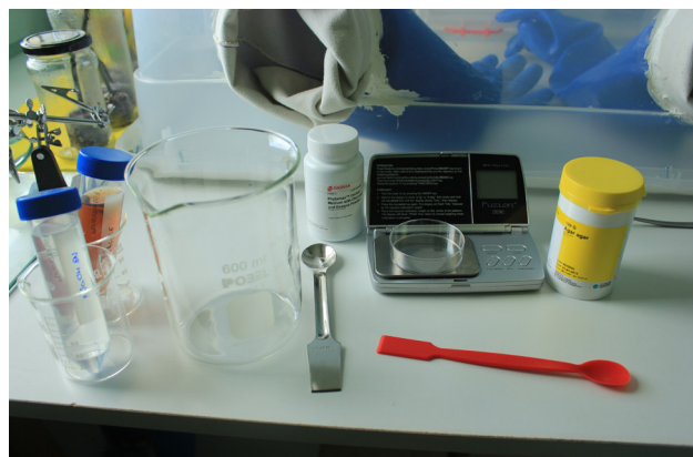
Todo a mano y preparado para empezar a preparar el medio. De izquierda a derecha, tampones para modificar el pH, vaso precipitados 600ml, cuchara acero inoxidable, al fondo medio de cultivo en polvo, balanza de precisión y agar-agar de laboratorio (Foto © Alberto Martínez).
