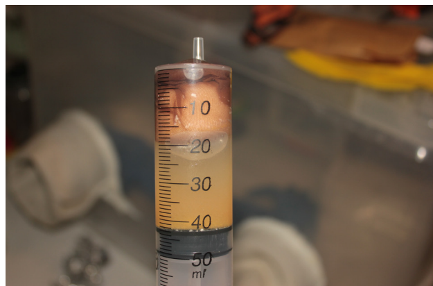
Método de esterilización de semillas mediante jeringuilla de alimentación. Solución agua al 10% de lejía mas unas gotas de un detergente tensioactivo (Foto © Alberto Martínez).
